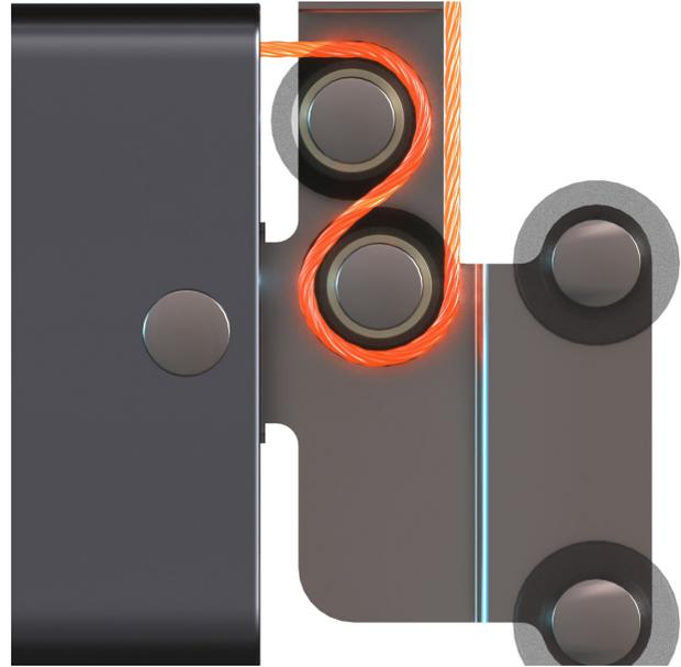
**Bei Systemen größer als 5 m Breite:** Führen Sie das Seil entsprechend der Darstellung über die Seilrollen des Mittelstabilisators und der Mittelkonsole.
