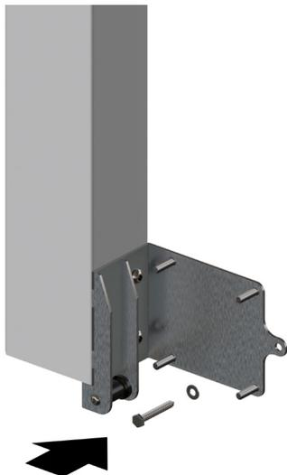
4.1.2 Befestigen Sie die Haltetasche im vorbereiteten Bohrloch der Wand.
