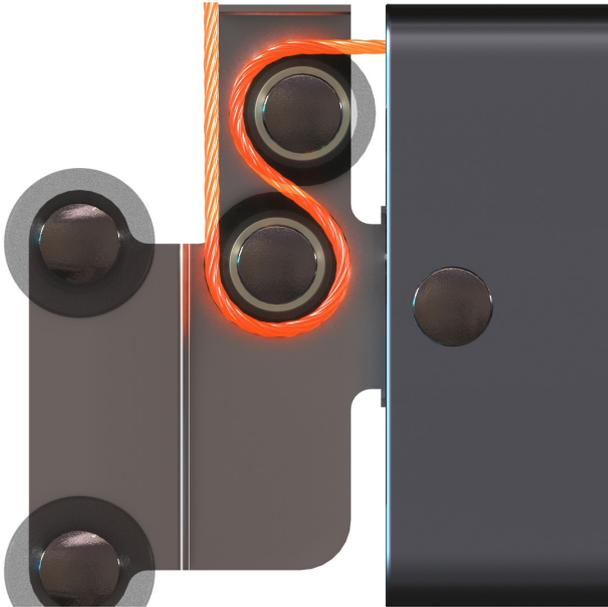
**Alle Systeme:** Führen Sie das Drahtseil um die Seilrollen des gegenüberliegenden Steckschlittens.
