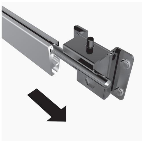
Schieben Sie danach die obere Kederschiene über die Haltebolzen der befestigten Spannhalter.
